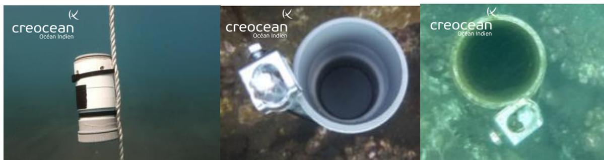
**Figure 1 : Pose de piège à particules au-dessus du fond (à gauche et au milieu) et relève après 15 jours (à droite)**
